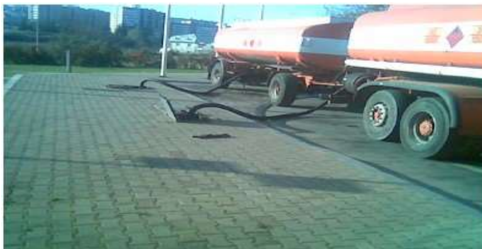
Slika 4. Primer prikaza mesta priključaka creva za pretakanje svetlih goriva najčešćih mesta otkaza
