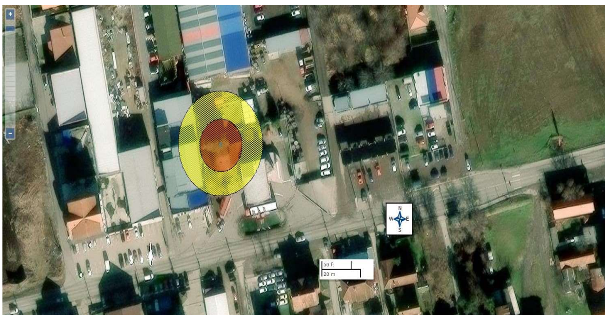
Slika 12. Zona opasnosti od udesa dobijene modeliranjem za efekat paljenja gasnog (parnog) oblaka TNG
