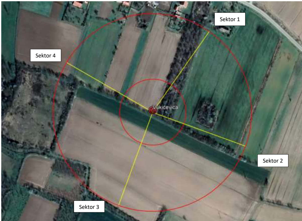
Slika 2.5 Pravci zračenja antenskih sistema predmetne bazne stanice
