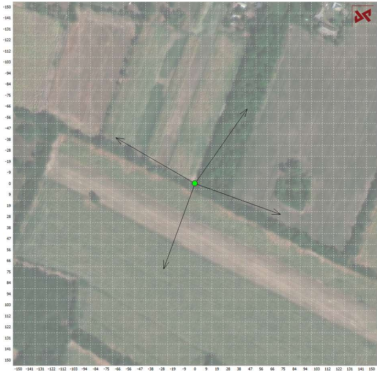
Slika - Prikaz pravaca zračenja antena i pozicije okolnih objekata
