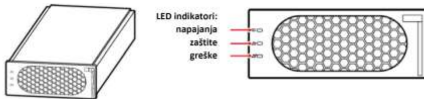
Slika 3.4 LED Indikatori na PSU jedinici
