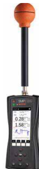
Širokopolasni instrument za merenje jačine el. polja
