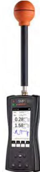
Širokopolasni instrument za merenje jačine el. polja
