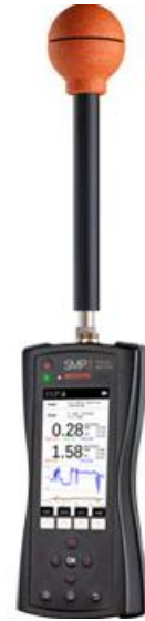
Širokopoljarni instrument za merenje jačine el. polja
