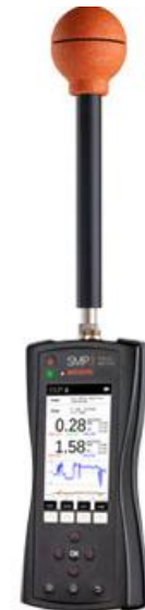
Širokopolasni instrument za merenje jačine el. polja
