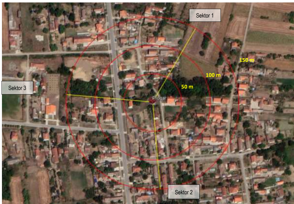
Slika 2.6 Pravci zračenja antenskog sistema BS PROGAR
