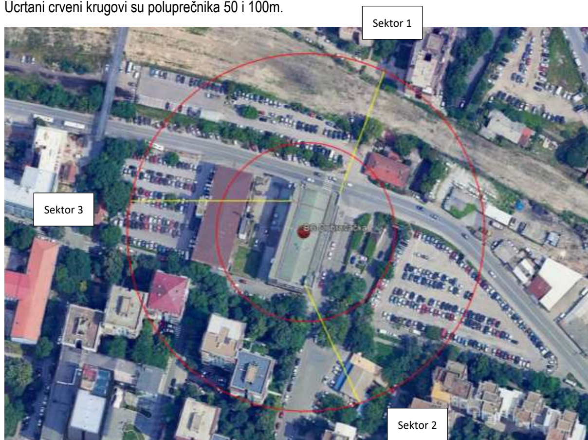
Slika 2.7 Pravci zračenja antenskih sistema predmetne bazne stanice
