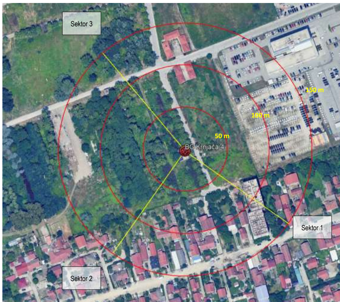
Slika 2.6 Pravci zračenja antenskog sistema BS BG KRNJACA 4
