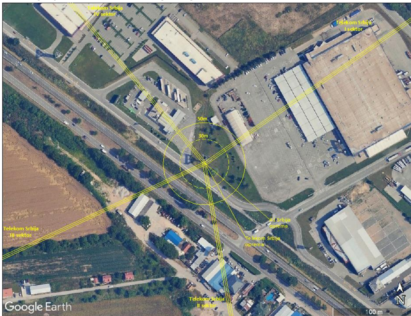
Slika 2.1 Dijagram zračenja radio bazne stanice "BG-Autoput za NS (Metro)" - BG621/BGU621/BGL621/BGO621/BGJ621
