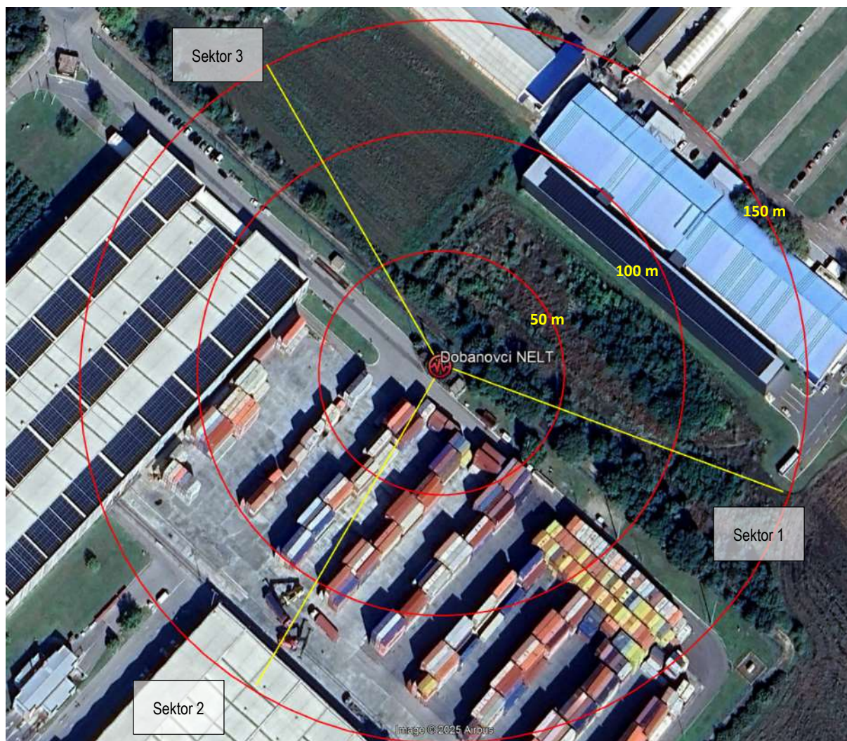
Slika 2.6 Pravci zračenja antenskog sistema BS DOBANOVCI NELT
