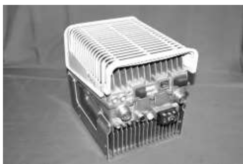
Slika 3.3 Izgled jednosektorskih Nokia Flexi radio modula
