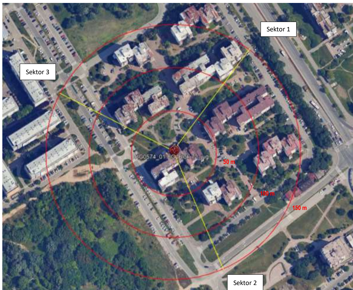
Slika 2.5 Pravci zračenja antenskih sistema predmetne bazne stanice
