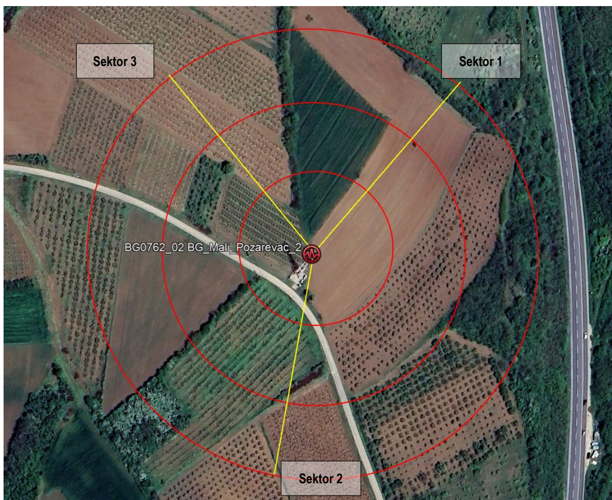
Slika 2.5 Pravci zračenja antenskih sistema predmetne bazne stanice
