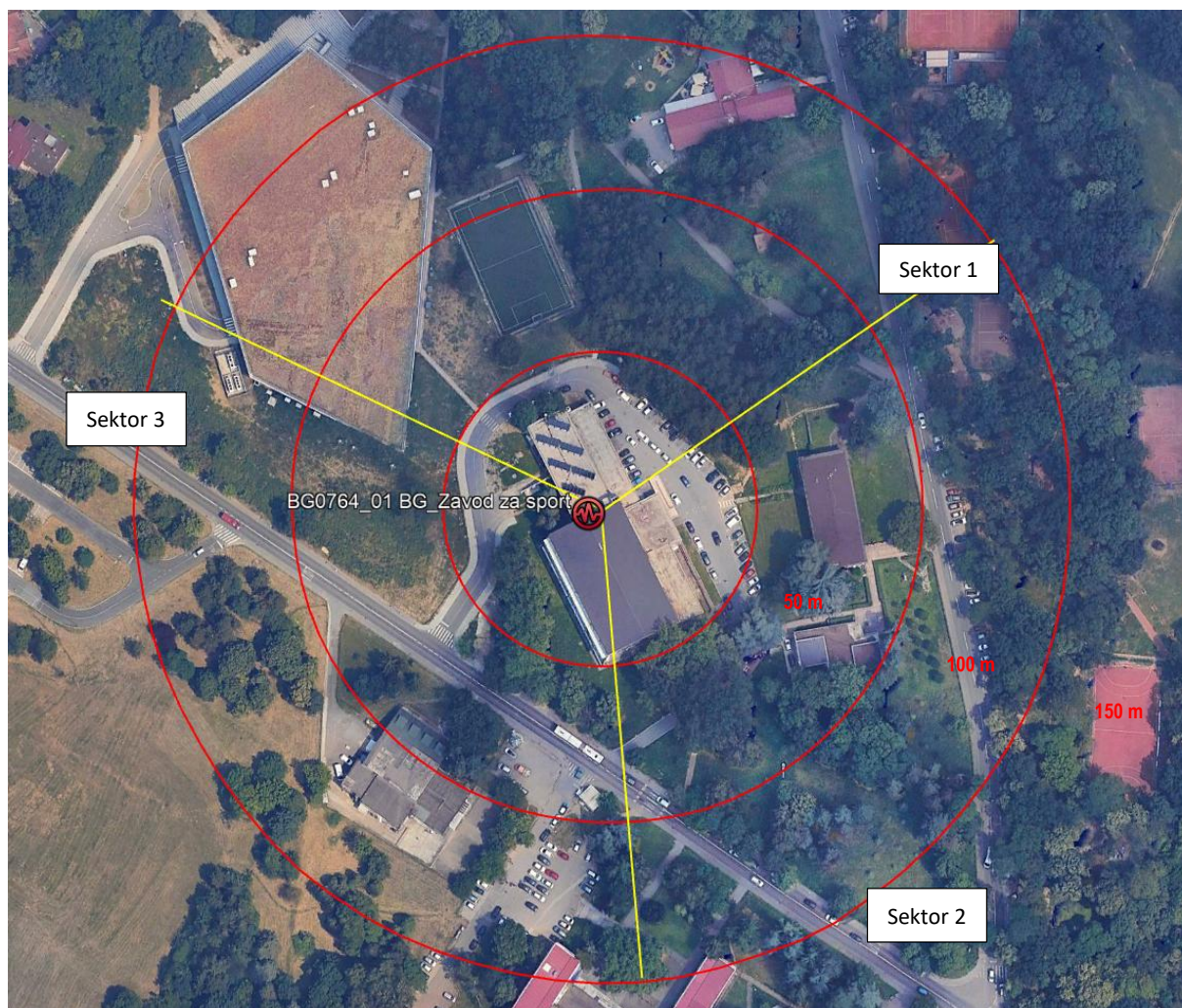
Slika 2.7 Pravci zračenja antenskih sistema predmetne bazne stanice
