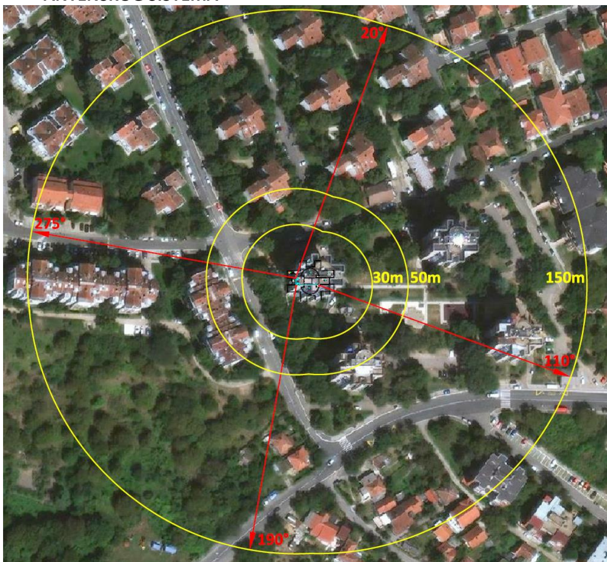
Slika 2.4 Dijagram zračenja predmetne radio bazne stanice „BG - Petlovo brdo“- BG83/BGH83/BGU83/BGL83/BGO83/BGJ83 3
