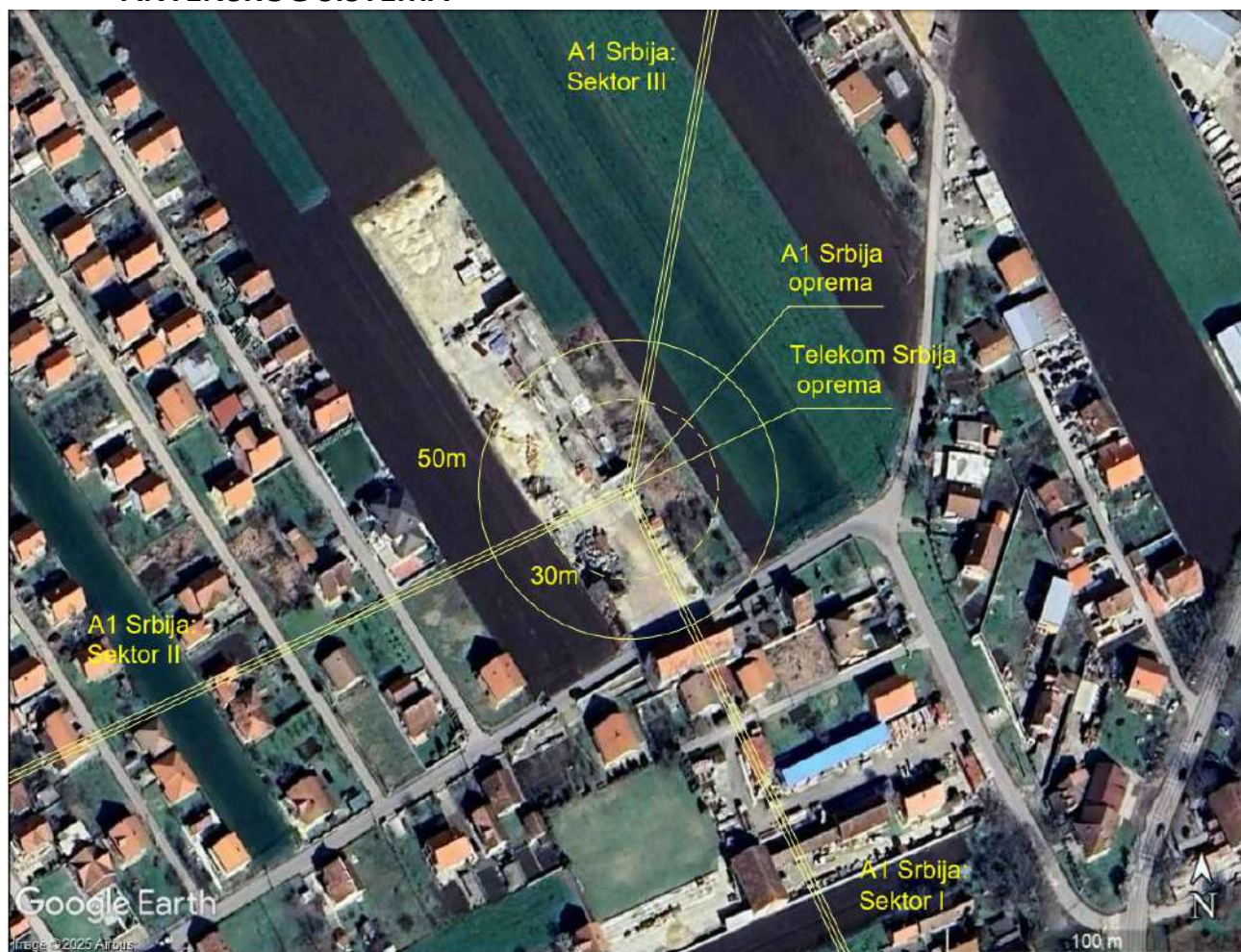
Slika 2.4 Dijagram zračenja planirane radio bazne stanice „BG5028_01 BG_Batajnica_8” 3
