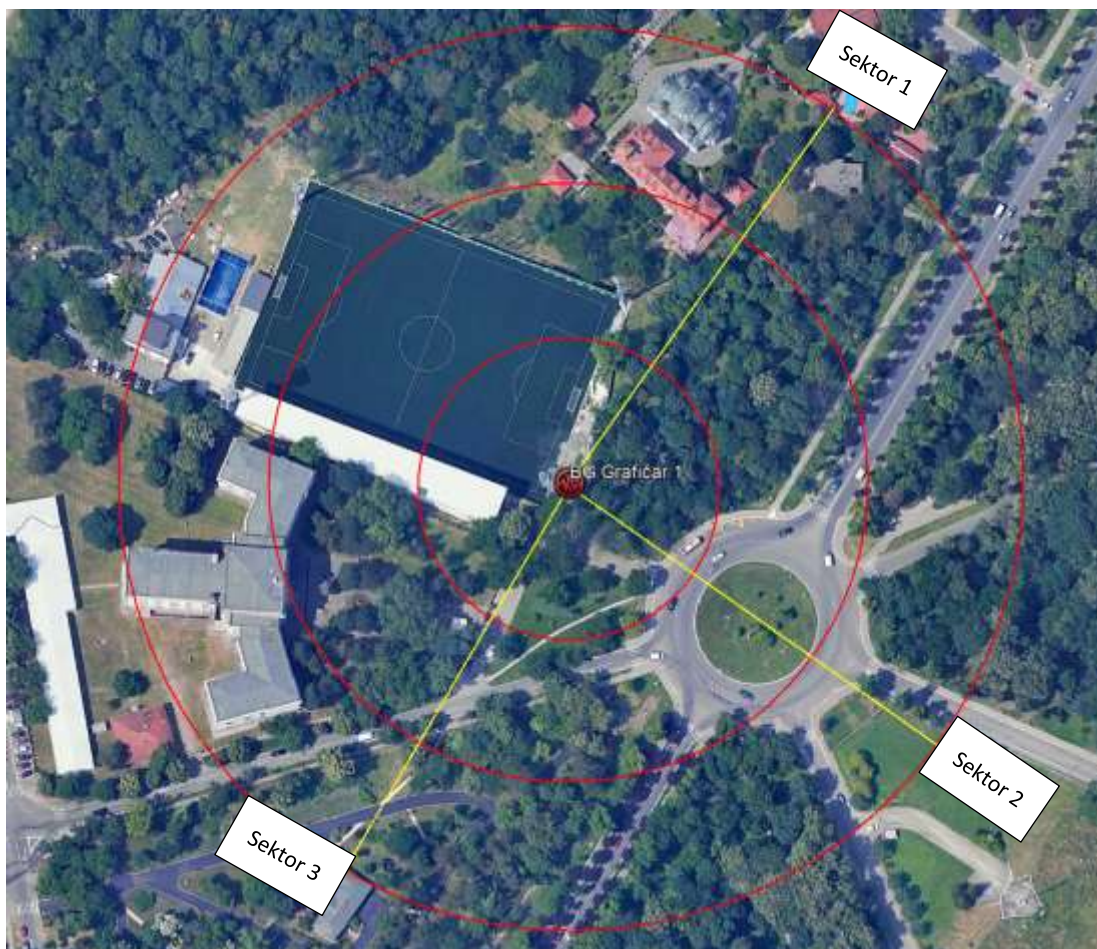
Slika 2.7 Pravci zračenja antenskih sistema predmetne bazne stanice
