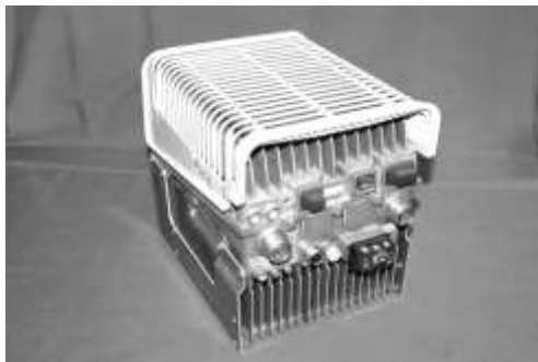
Slika 3.7 Izgled jednosektorskih Nokia Flexi radio modula
