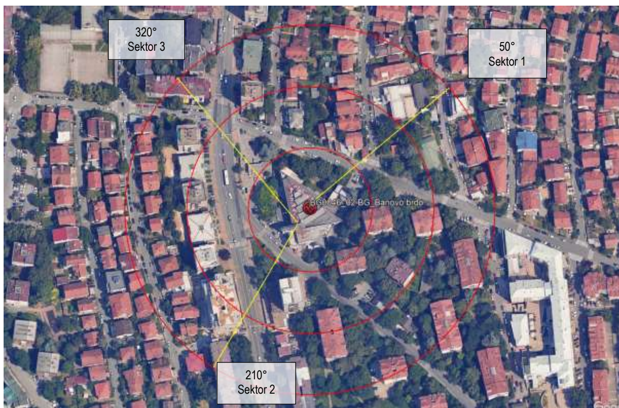
Slika 2.7 Pravci zračenja antenskog sistema predmetne bazne stanice
