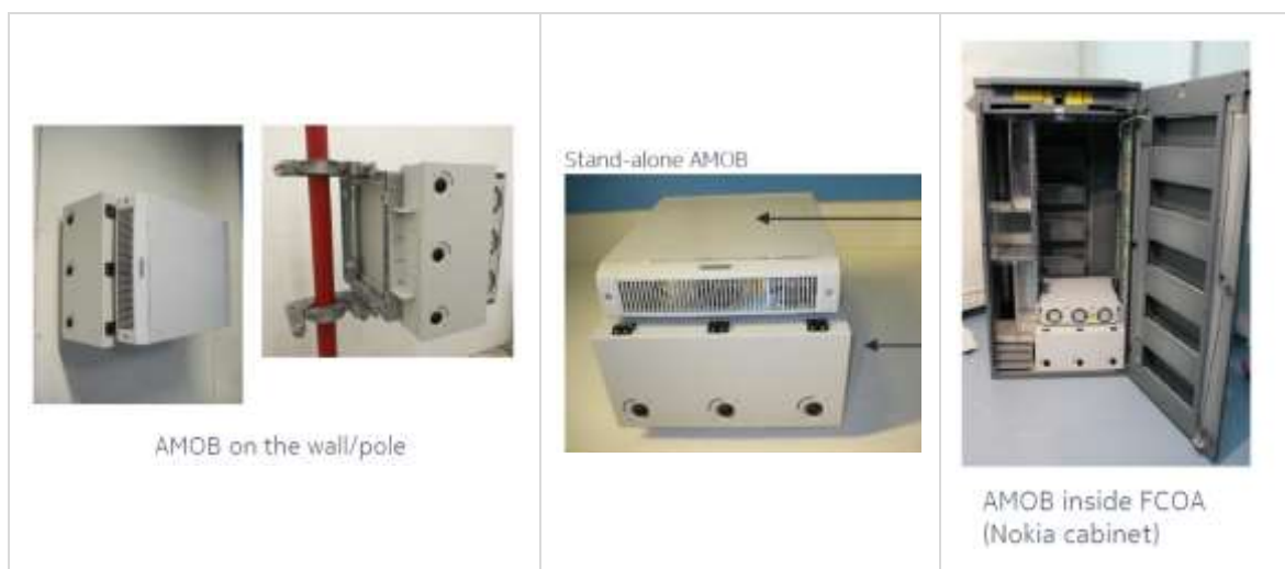
Slika 3.2 AMOB kućište instalacija
