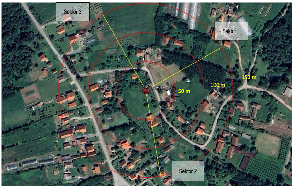
Slika 2.6 Pravci zračenja antenskog sistema buduće BS ŠILJAKOVAC
