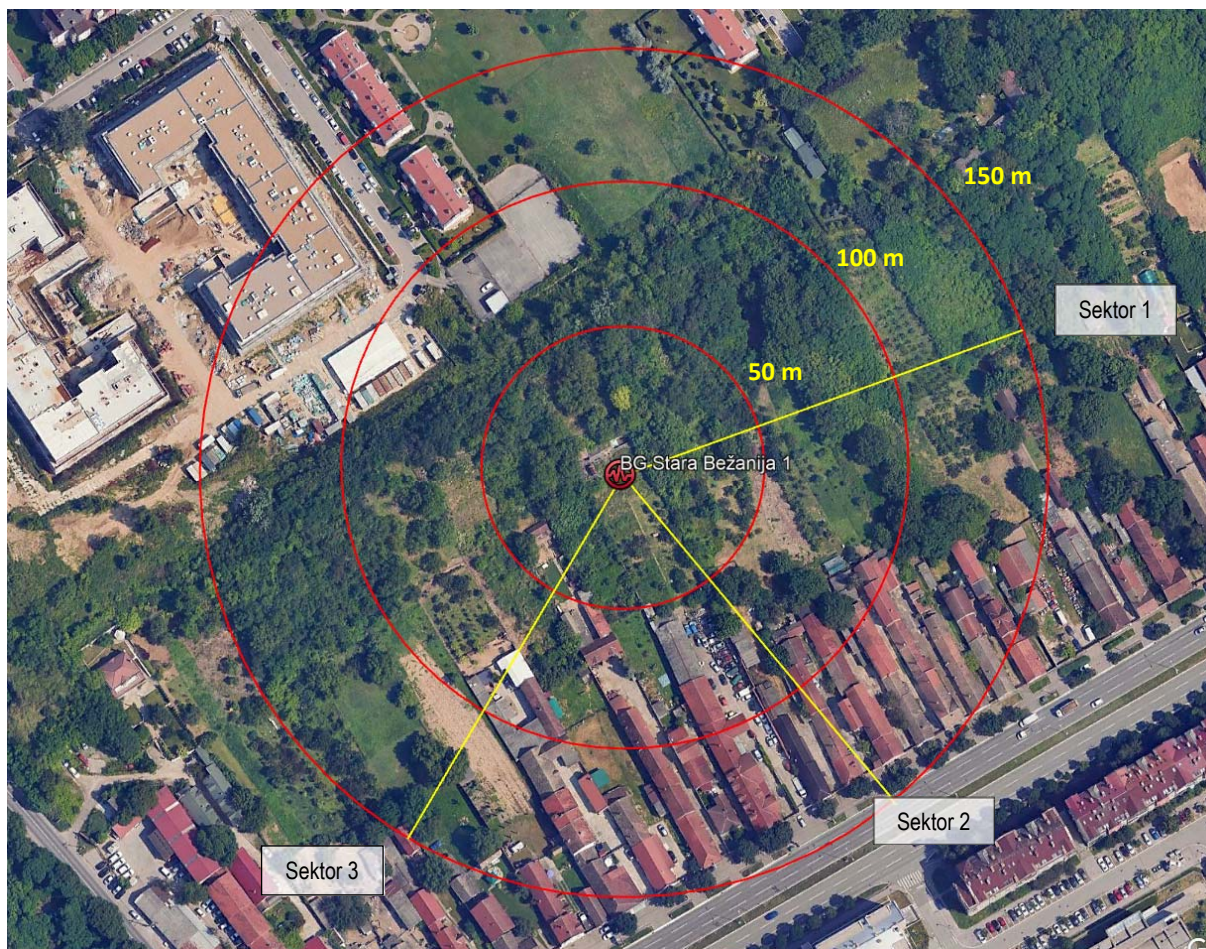
Slika 2.6 Pravci zračenja antenskog sistema BS BG STARA BEŽANIJA 1
