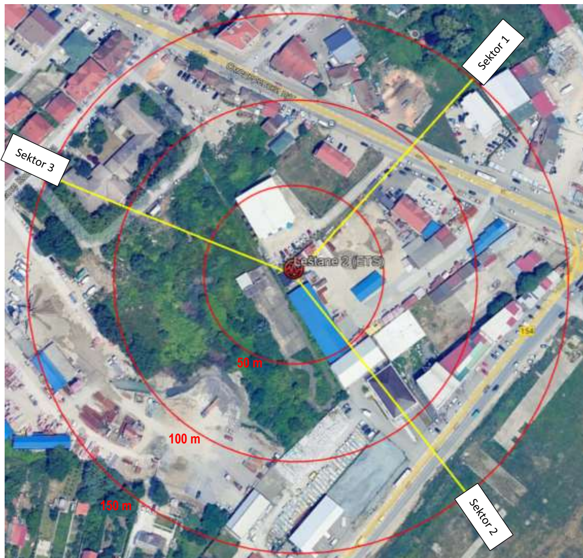
Slika 2.7 Pravci zračenja antenskih sistema predmetne bazne stanice
