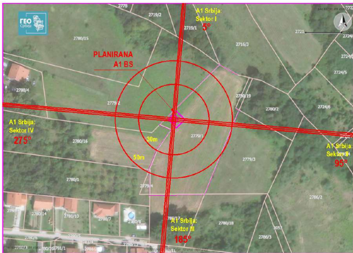
Slika 5.1 Dijagram zračenja radio bazne stanice «BG0934_02 BG_Barajevo_2»
