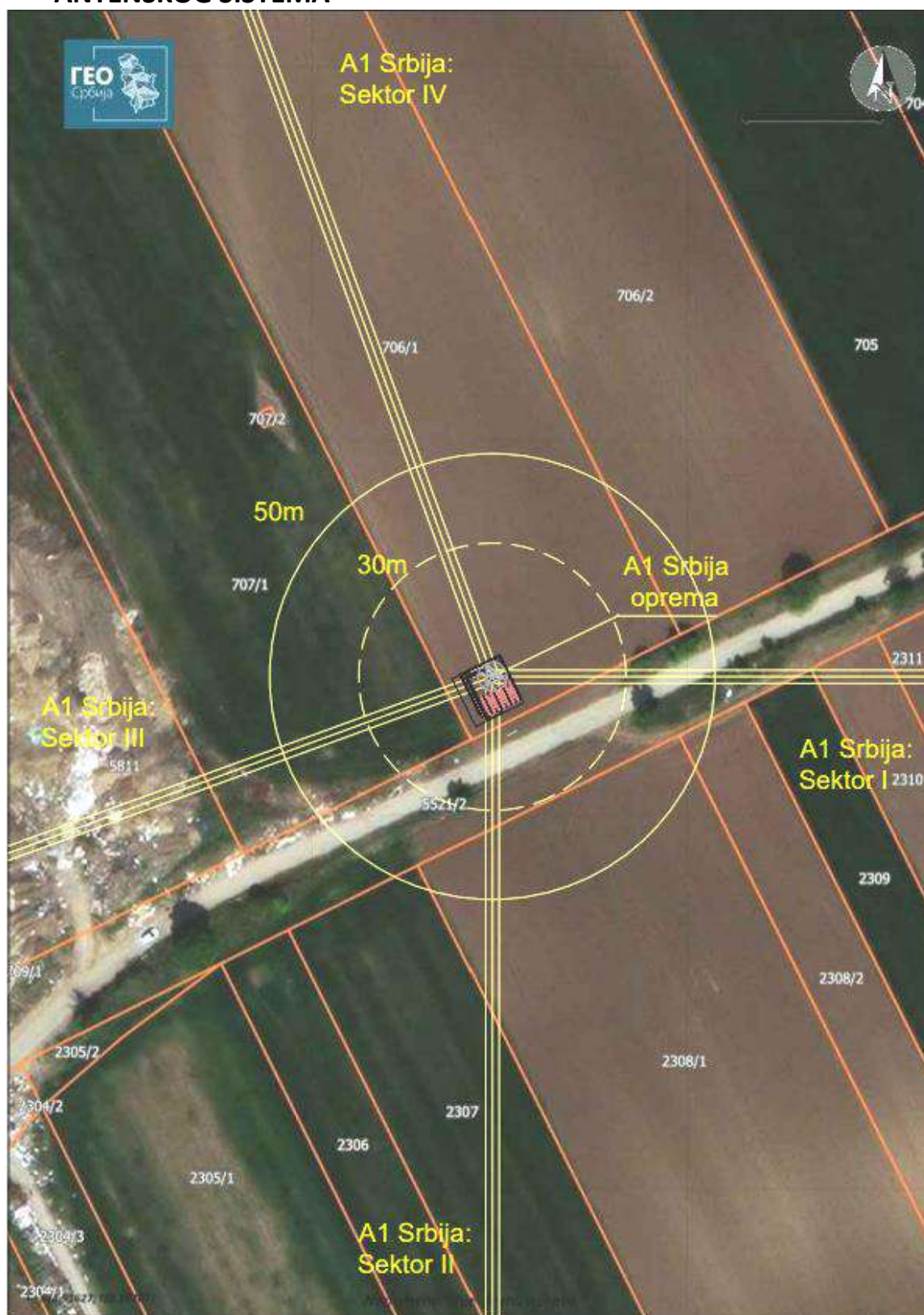
Slika 2.4 Dijagram zračenja planirane radio bazne stanice „BG0551_02 BG_Batajnica_Eko_Unija“ 3
