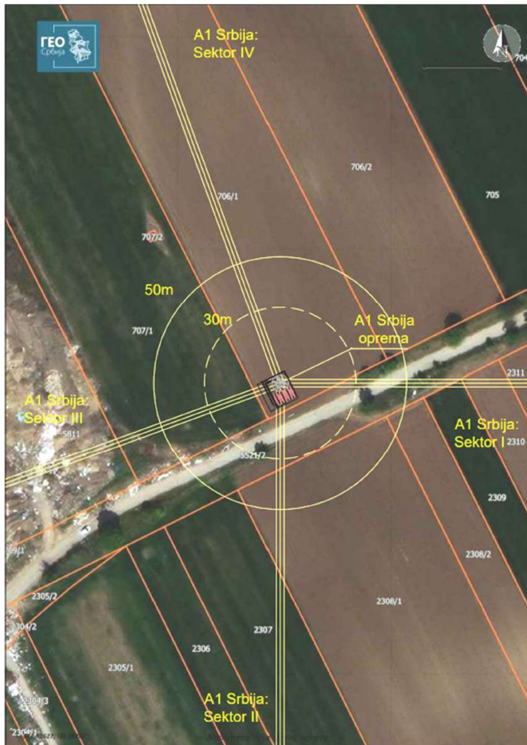
Slika 5.1 Dijagram zračenja radio bazne stanice «BG0551_02 BG_Batajnica_Eko_Unija»
