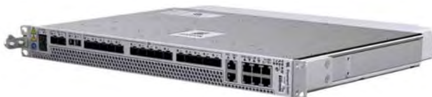
Slika 3.3 Izgled Baseband 6620 / 6630 jedinice
