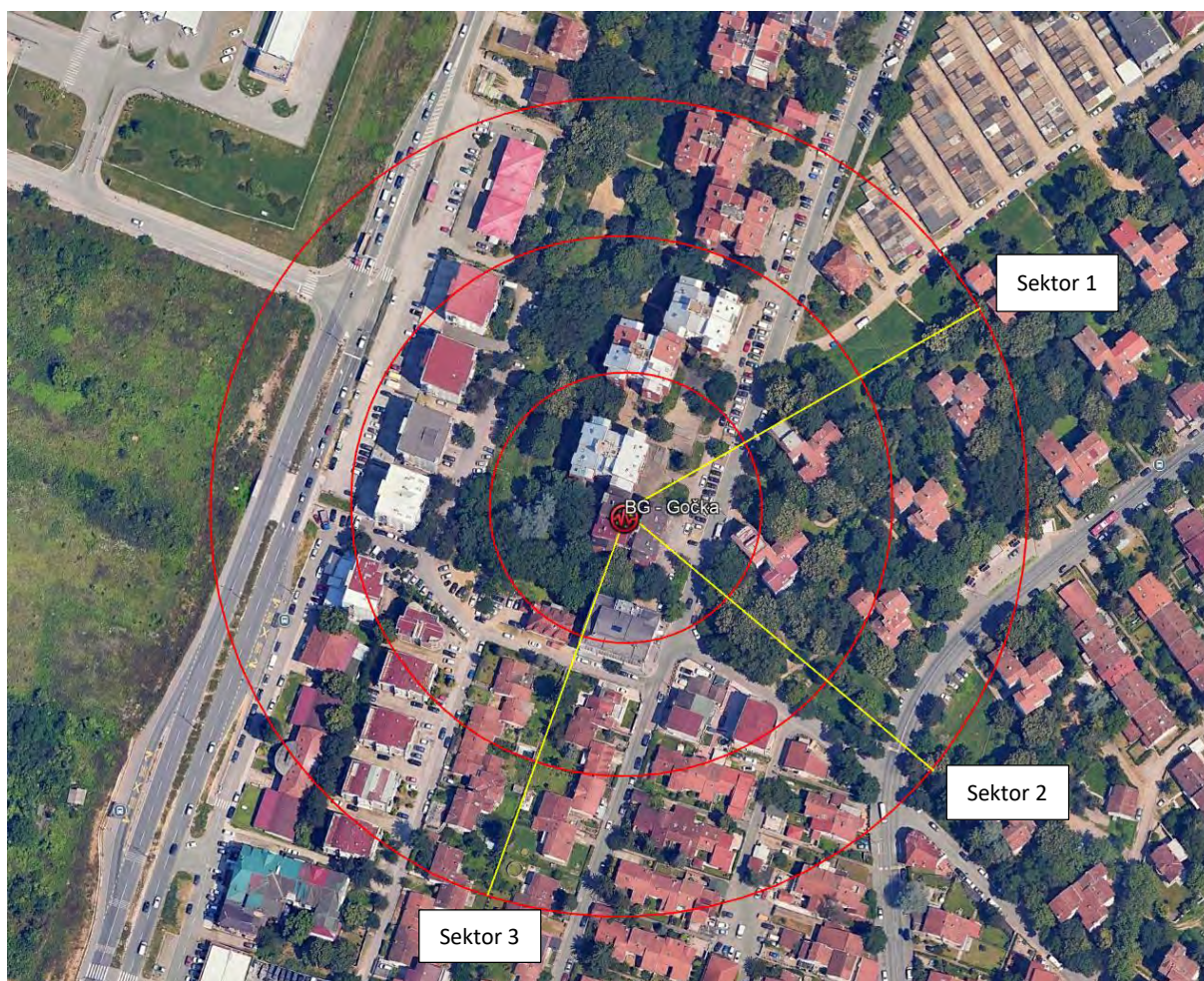
Slika 2.4 Pravci zračenja antenskih sistema predmetne bazne stanice
