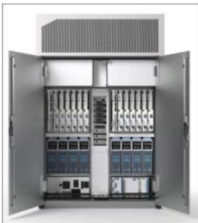
Slika 8.1 Izgled RBS 6102 kabineta
