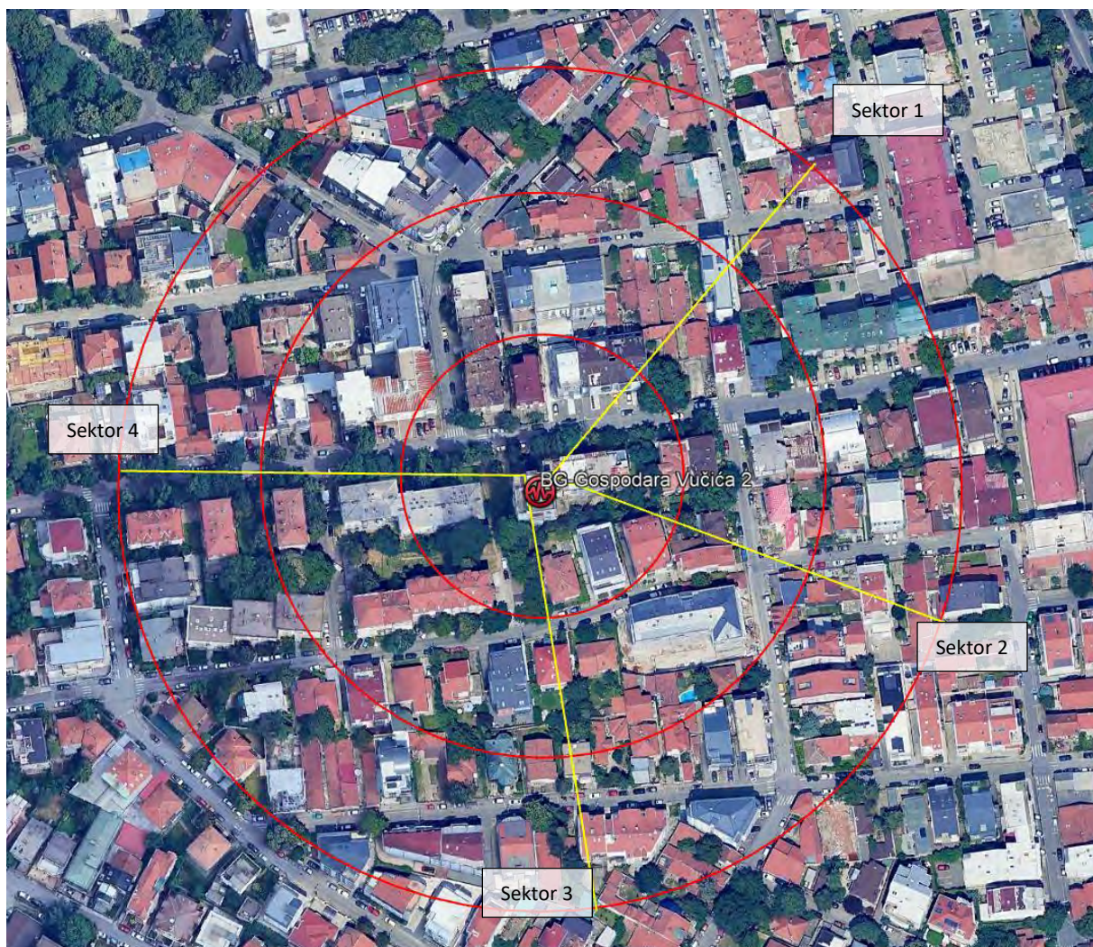
Slika 2.5 Pravci zračenja antenskih sistema predmetne bazne stanice
