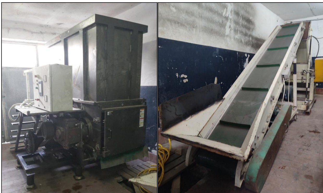
Слика 8. Линија 2 (шредер – транспортна трака – млин)
