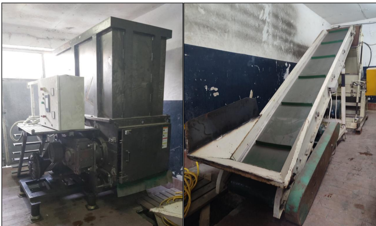
Слика 8. Линија 2 (шредер – транспортна трака – млин)
