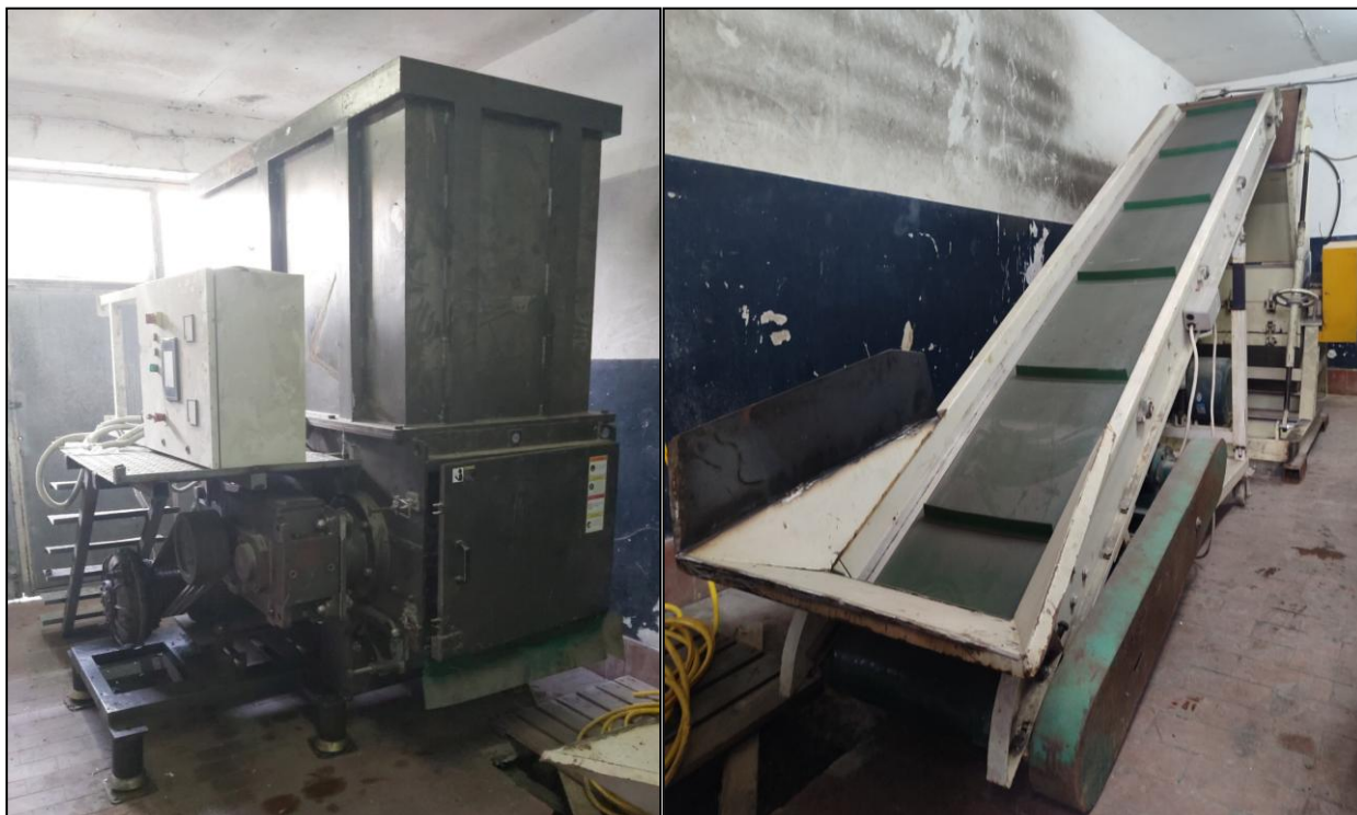
Слика 8. Линија 2 (шредер – транспортна трака – млин)
