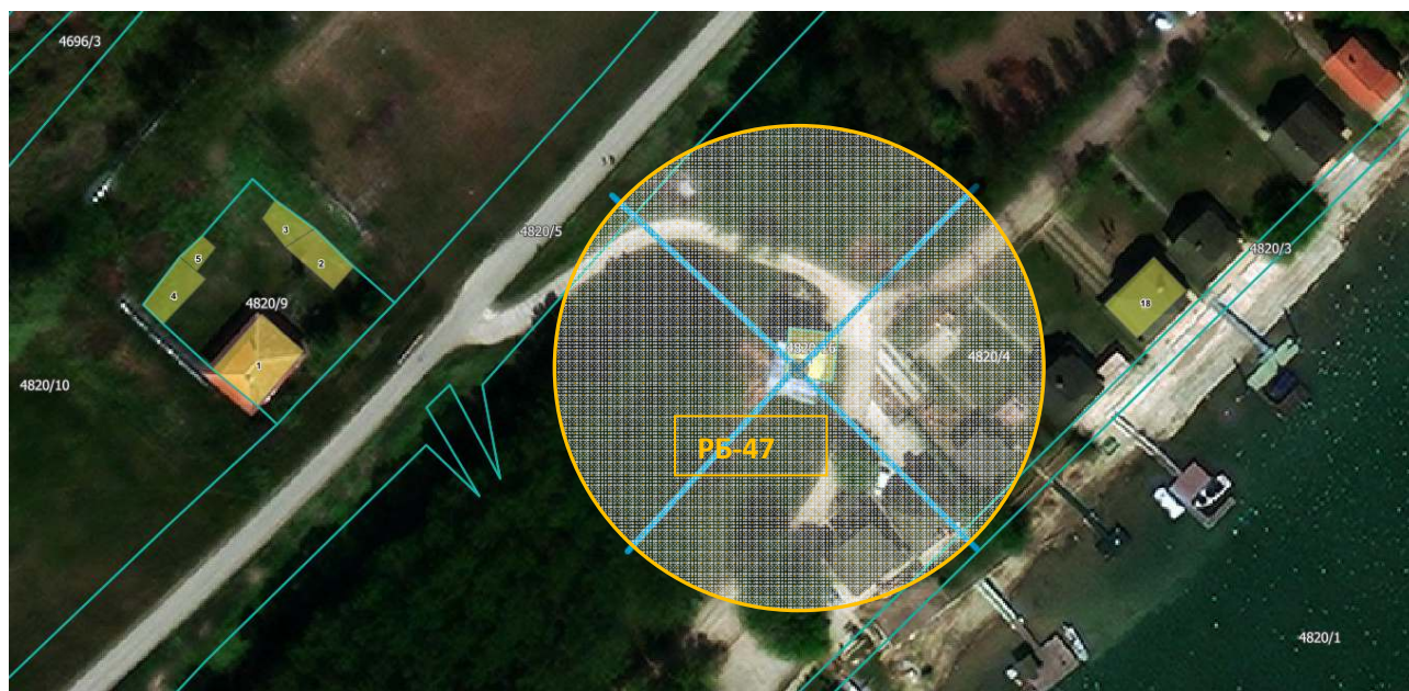
Слика 6 – Планирана зона за утискивање нових дрена на бунару РБ-47
