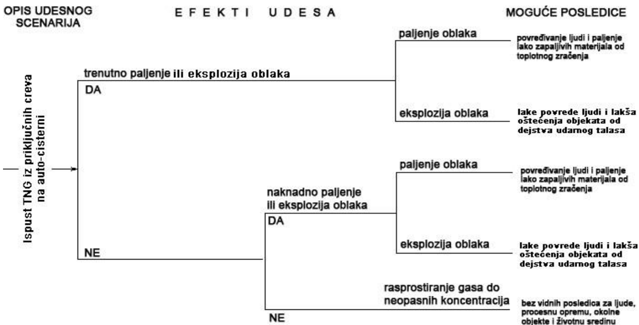
Slika 3.14. Šema razvoja udesne situacije s mogućim pratećim efektima nakon ispusta TNG iz priključnog fleksibilnog creva za istakanje
