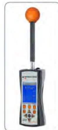
Širokopojasni instrument za merenje jačine el. polja
