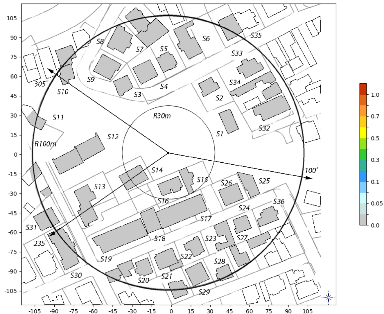
Slika 6.15: Rezultati proračuna faktora izlaganja unutar okolnih objekata za slučaj kada svi sistemi Telekom Srbija rade sa maksimalnim kapacitetom.
