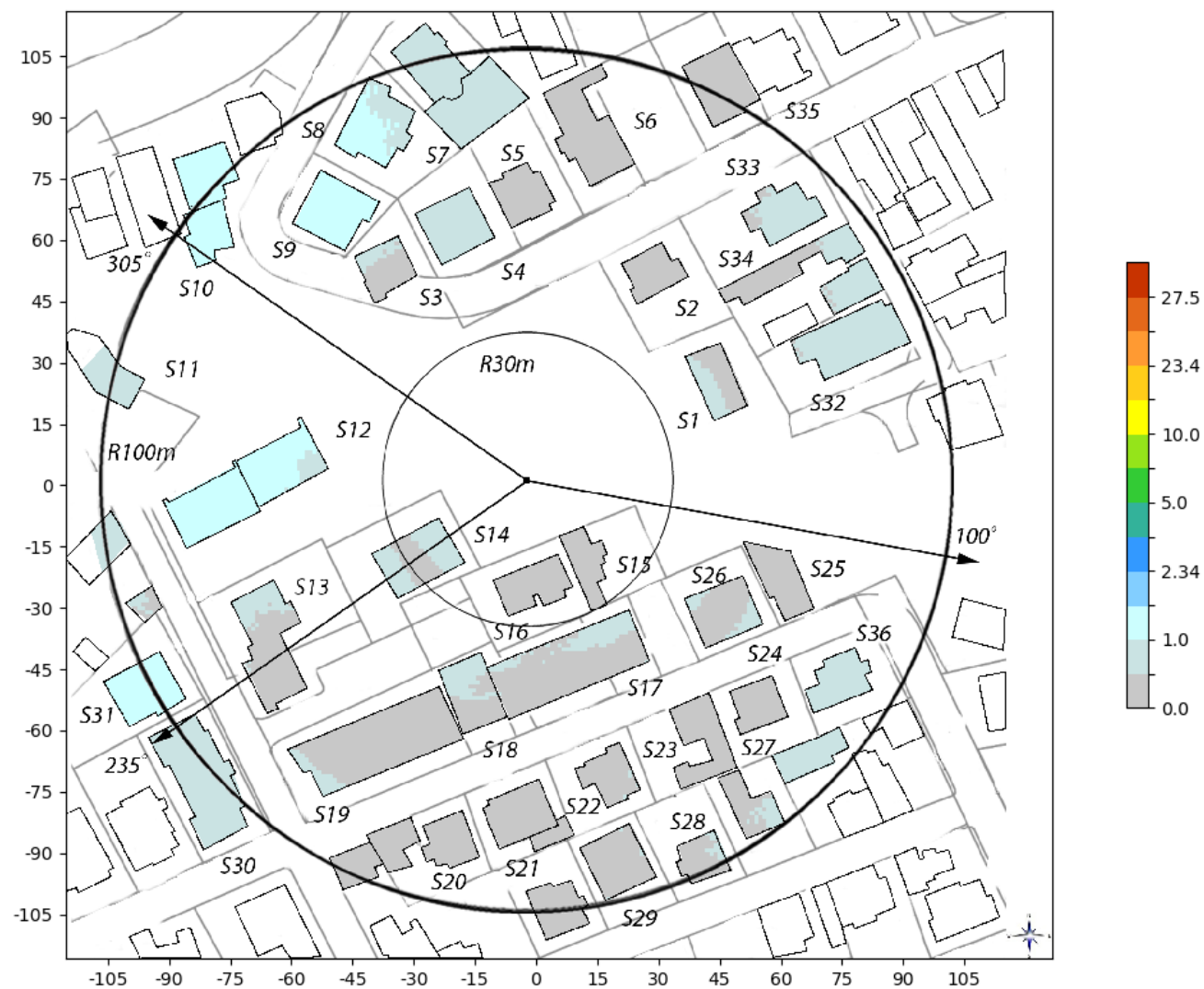
Slika 6.12: Rezultati proračuna jačine električnog polja unutar okolnih objekata za slučaj kada stanica LTE1800 Telekom Srbije radi sa maks. kapacitetom.
