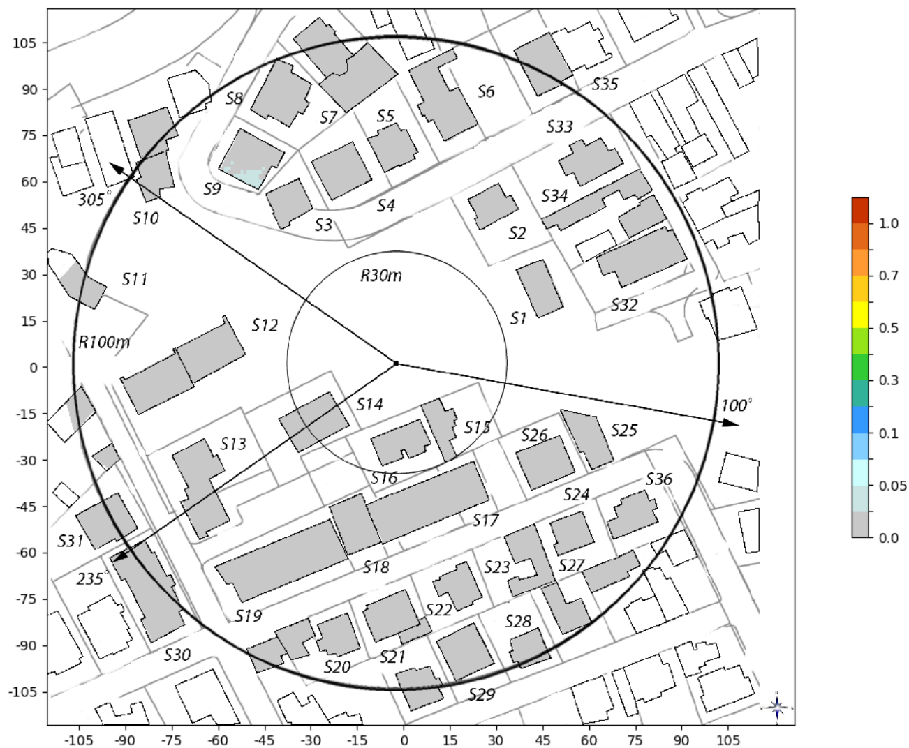
Slika 6.17: Rezultati proračuna faktora izlaganja unutar okolnih objekata za slučaj kada svi sistemi MTS i GSM-R rade sa maksimalnim kapacitetom.
