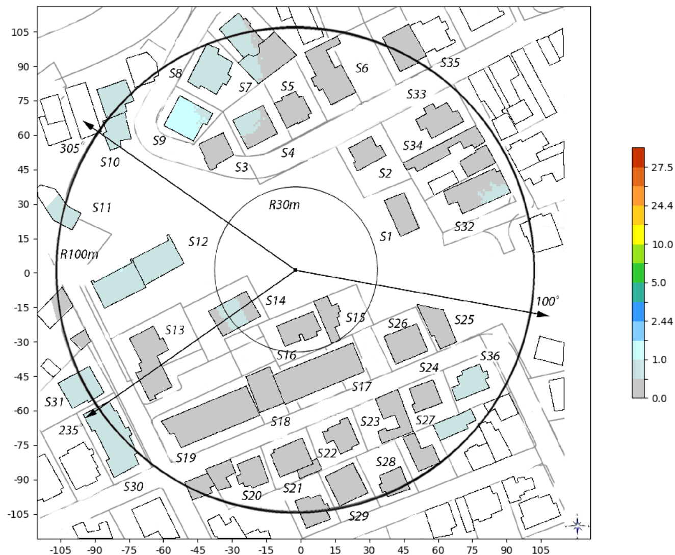
Slika 6.11: Rezultati proračuna jačine električnog polja unutar okolnih objekata za slučaj kada stanica UMTS2100 Telekom Srbije radi sa maks. kapacitetom.
