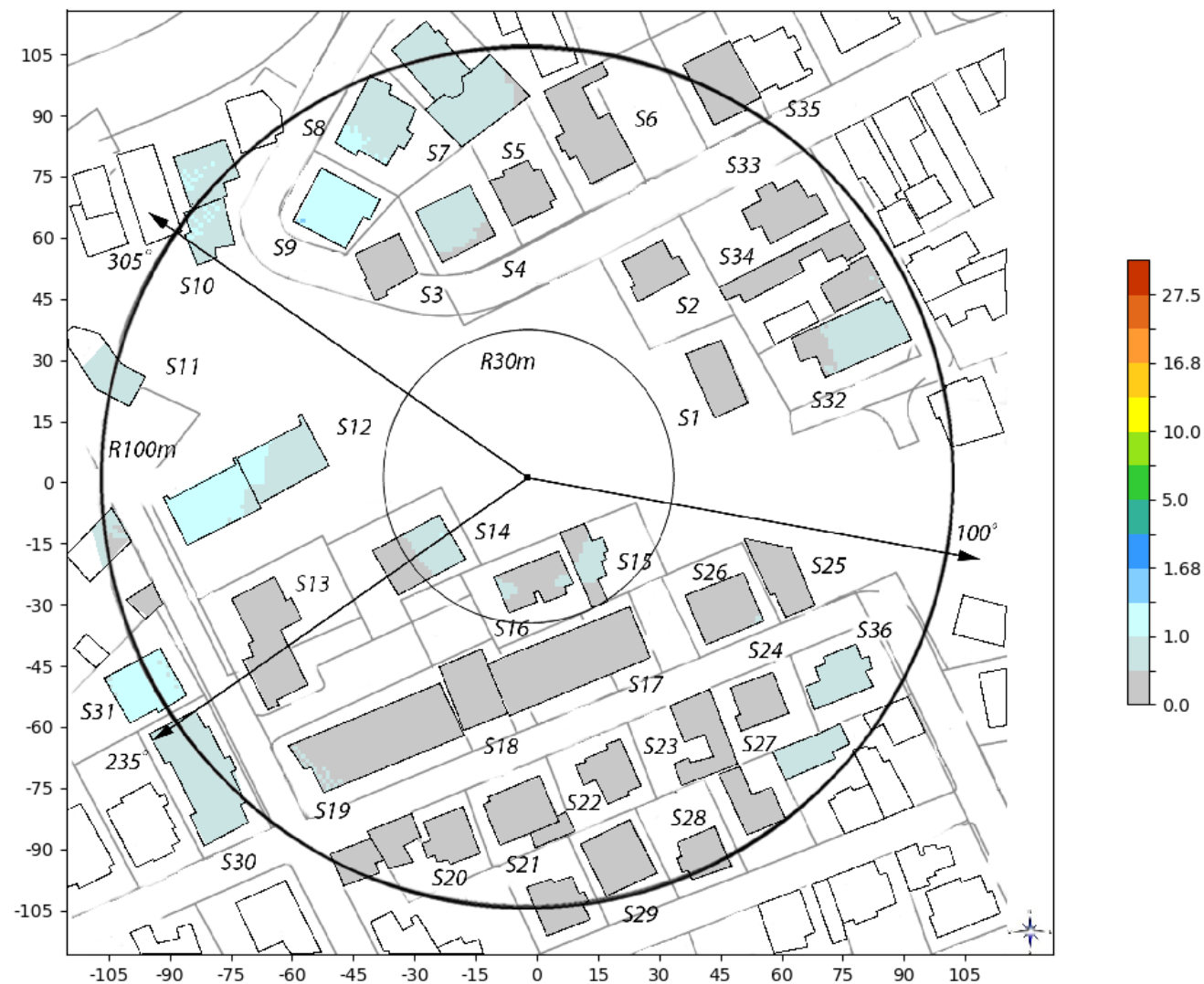
Slika 6.13: Rezultati proračuna jačine električnog polja unutar okolnih objekata za slučaj kada stanica GSM900 Telekom Srbije radi sa maks. kapacitetom.
