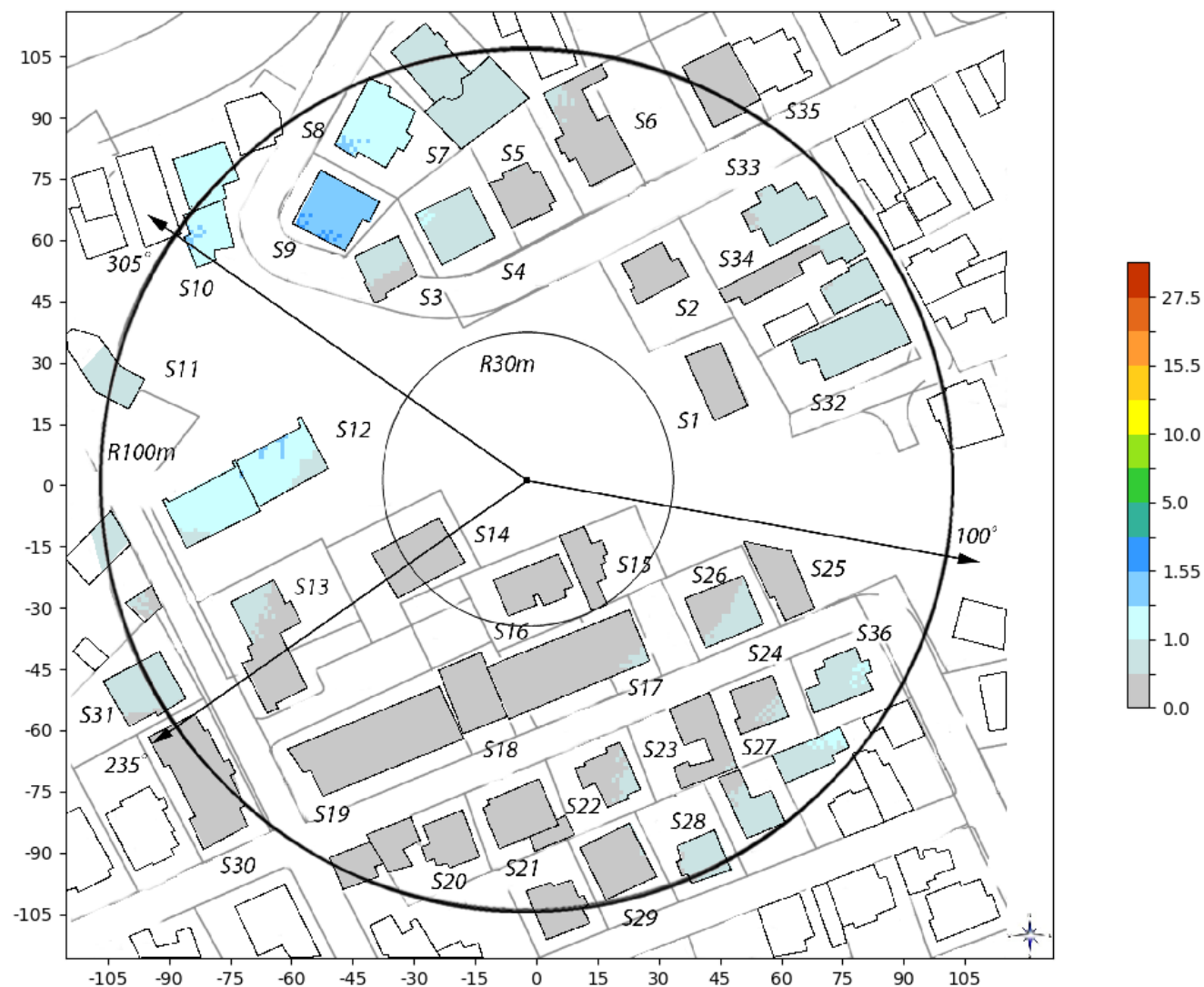
Slika 6.10: Rezultati proračuna jačine električnog polja unutar okolnih objekata za slučaj kada stanica LTE800 Telekom Srbije radi sa maks. kapacitetom.
