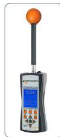
Širokopojasni instrument za merenje jačine el. polja
