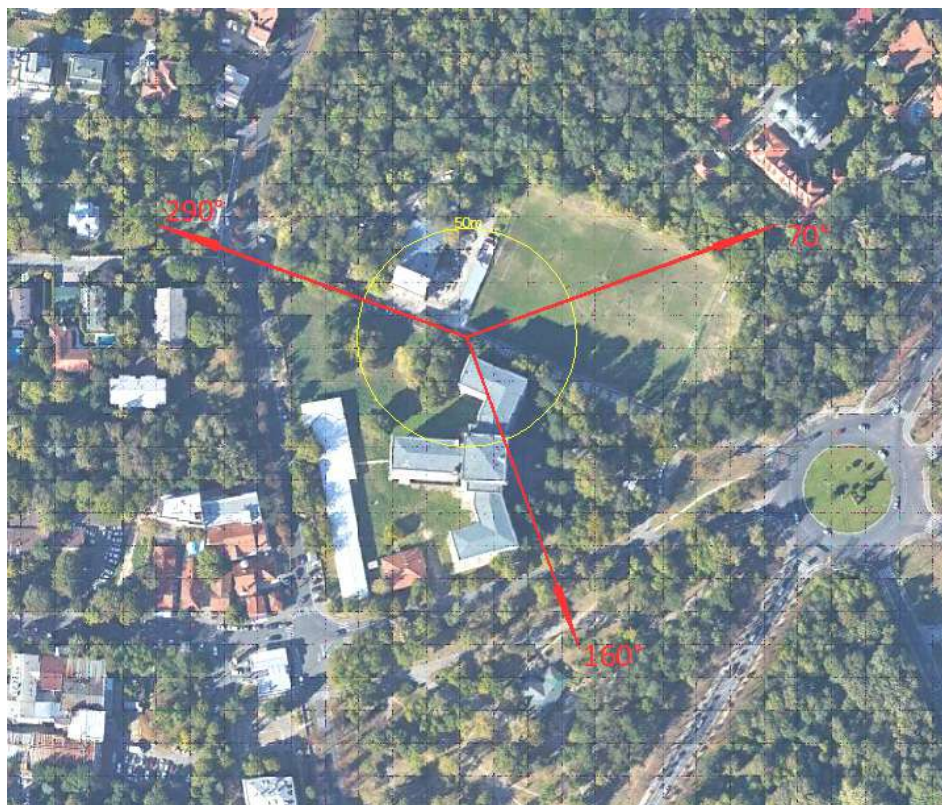
Slika 5.1 Dijagram zračenja radio bazne stanice na lokaciji «BG0916_01 BG_FK_Graficar»
