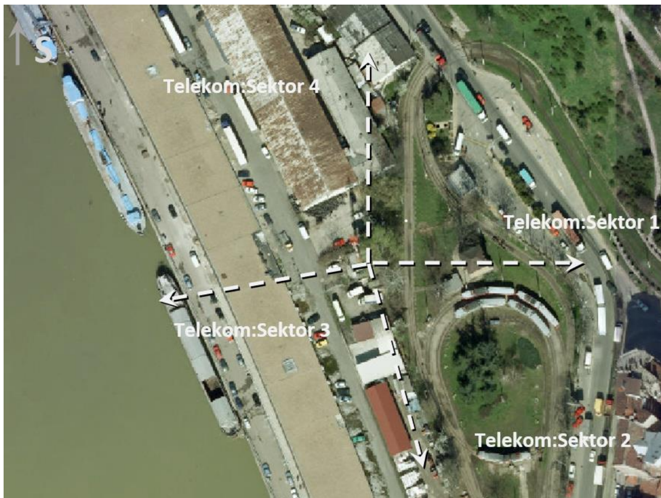
Slika 2.1 Dijagram zračenja radio bazne stanice „BG - Karađorđeva“ - BG89/BGU89/BGL89/BGO89/BGJ89
