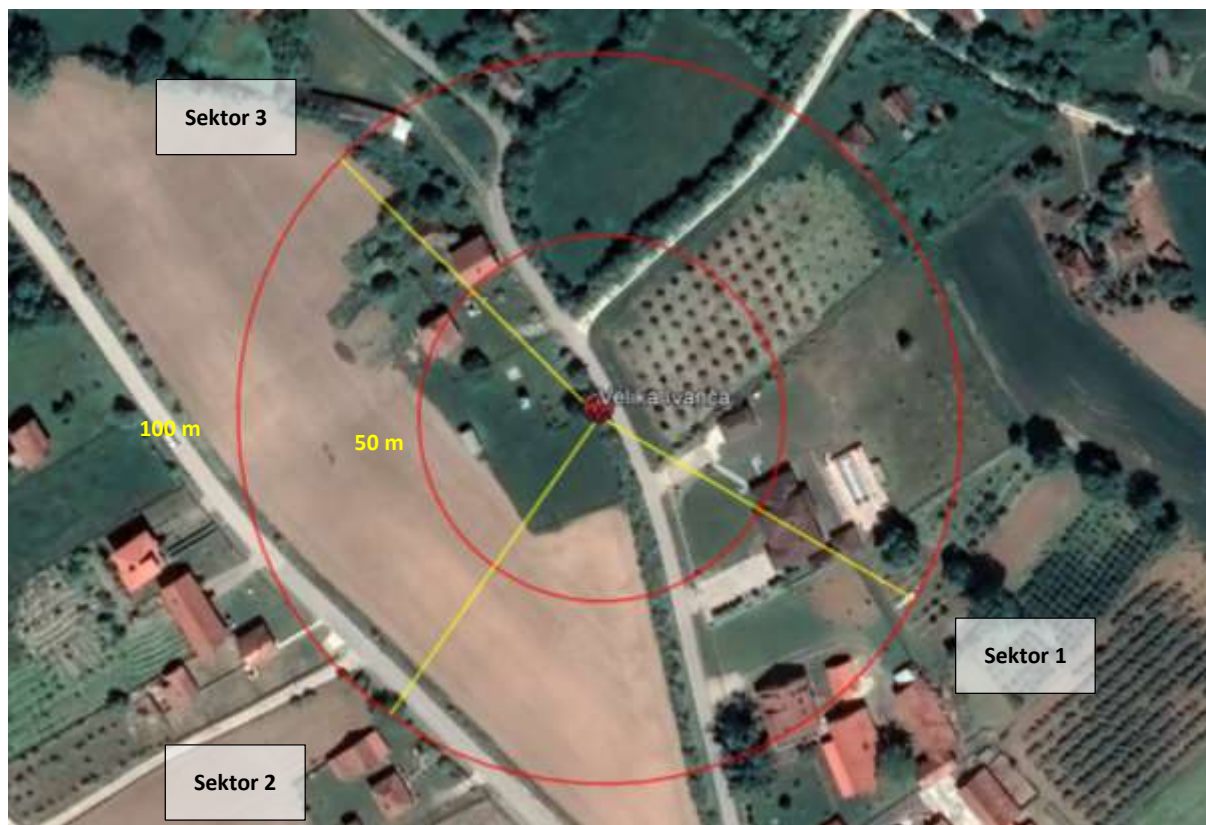
Slika 2.5 Pravci zračenja budućeg antenskog sistema BS VELIKA IVANČA
