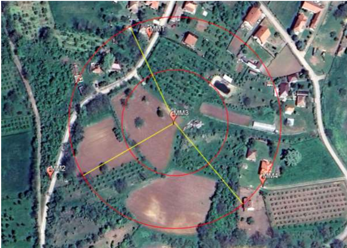
Slika 4.1 Prikaz pozicije mernih mesta u kojima su izvršena merenja nivoa EMP (crveno – krugovi poluprečnika 50 m i 100 m)
