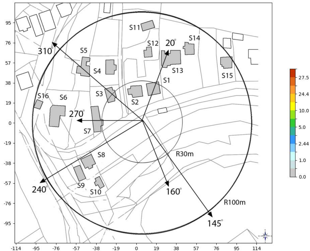
Slika 6.5. Rezultati proračuna jačine električnog polja unutar objekata, kada UMTS2100 bazna stanica operatora MTS radi sa maks. kapacitetom.
