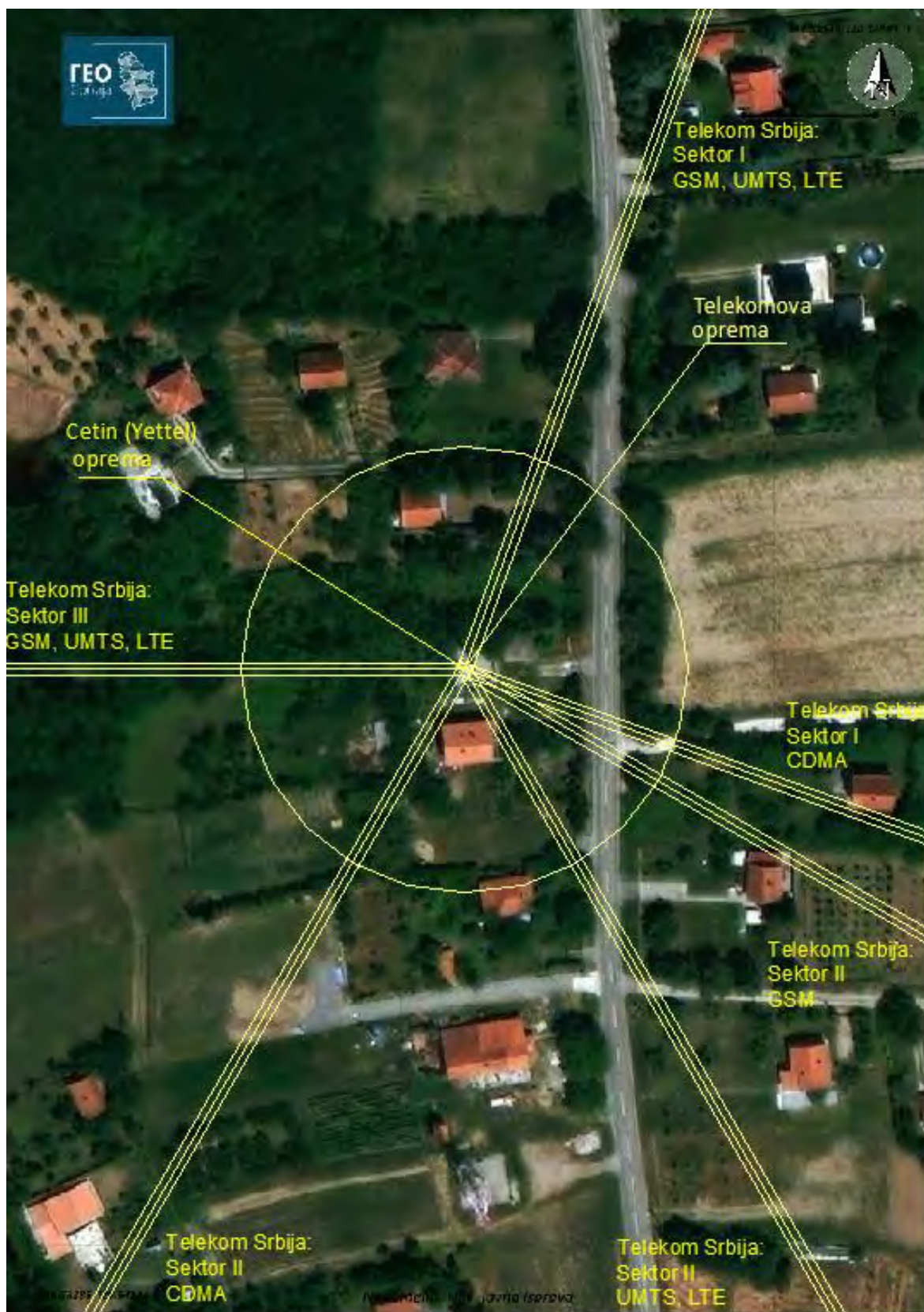
Slika 2.1 Dijagram zračenja radio bazne stanice "Sopot" - BG93/BGU93/BG93C113/BGL93/BGO93/BGJ93
