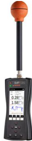
Širokopolasni instrument za merenje jačine el. polja
