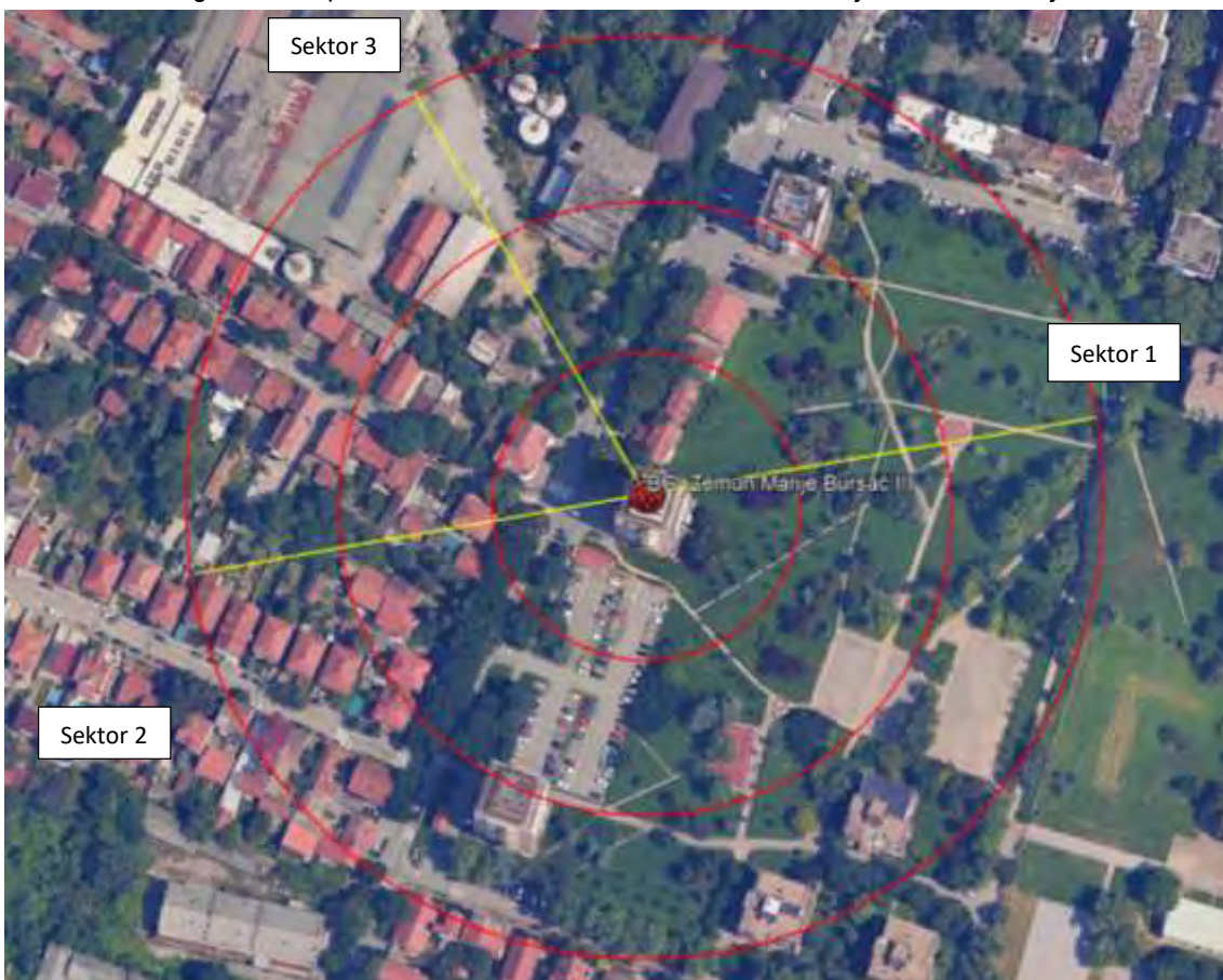
Slika 2.4 Pravci zračenja antenskih sistema predmetne bazne stanice
