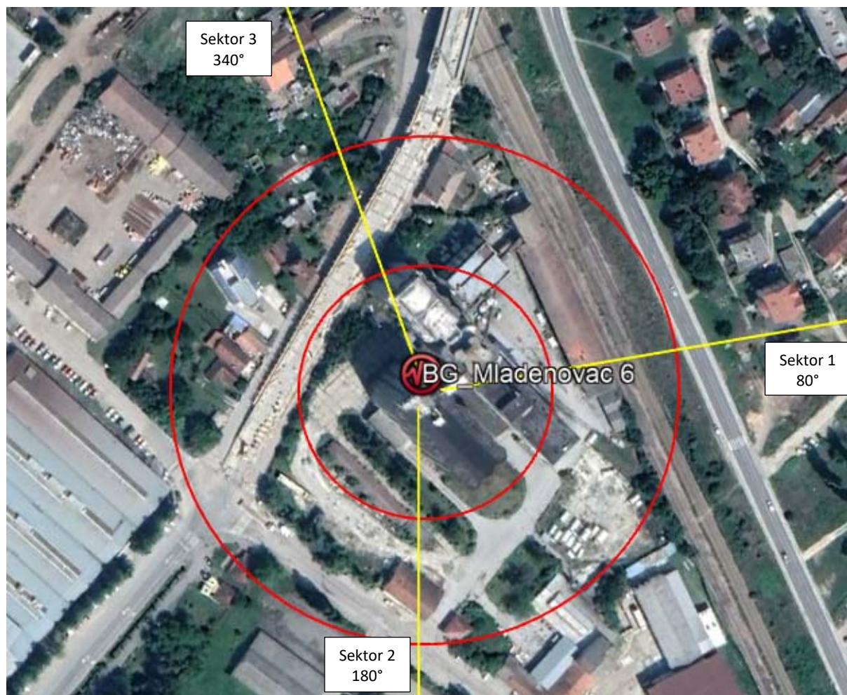
Slika 2.7 Pravci zračenja antenskih sistema predmetne bazne stanice
