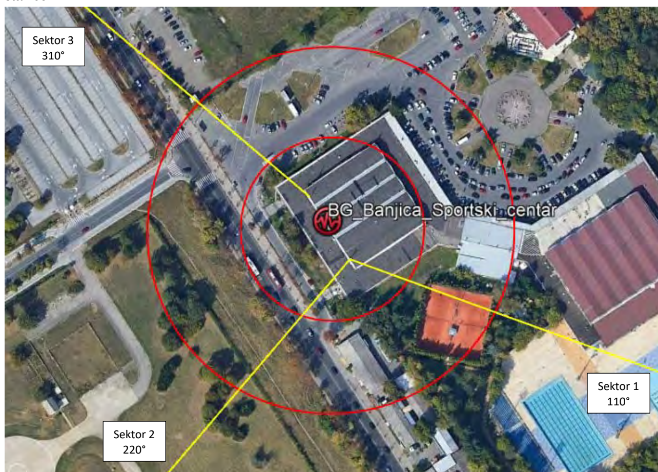
Slika 2.8 Pravci zračenja antenskih sistema BG0052_03 – BG_BANJICA_SPORTSKI_CENTAR
