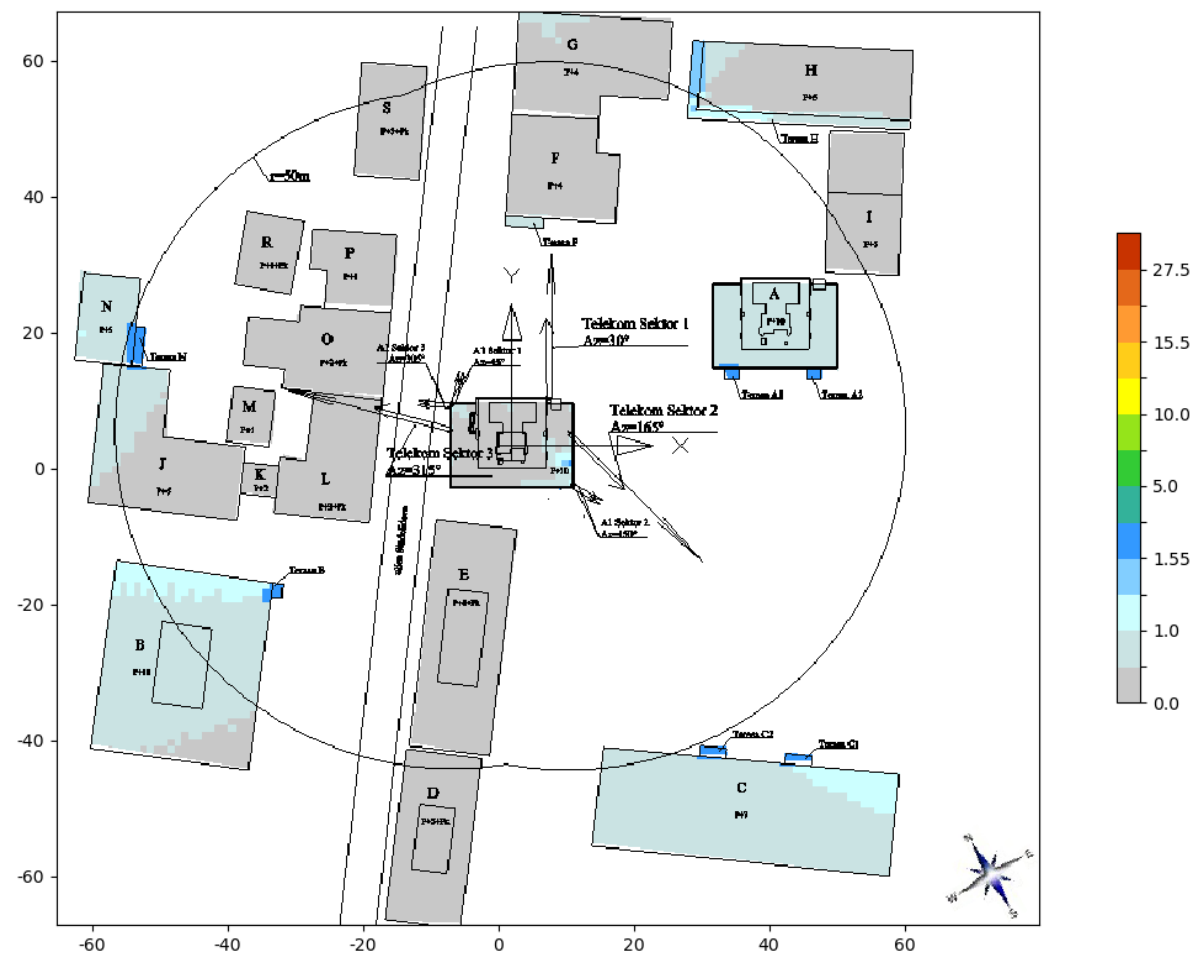
Slika 6.4. Rezultati proračuna jačine električnog polja u okolnim objektima na poslednjim spratovima/ spratovima od interesa za slučaj kada bazna stanica LTE800 Telekom Srbija radi sa maksimalnim kapacitetom.
