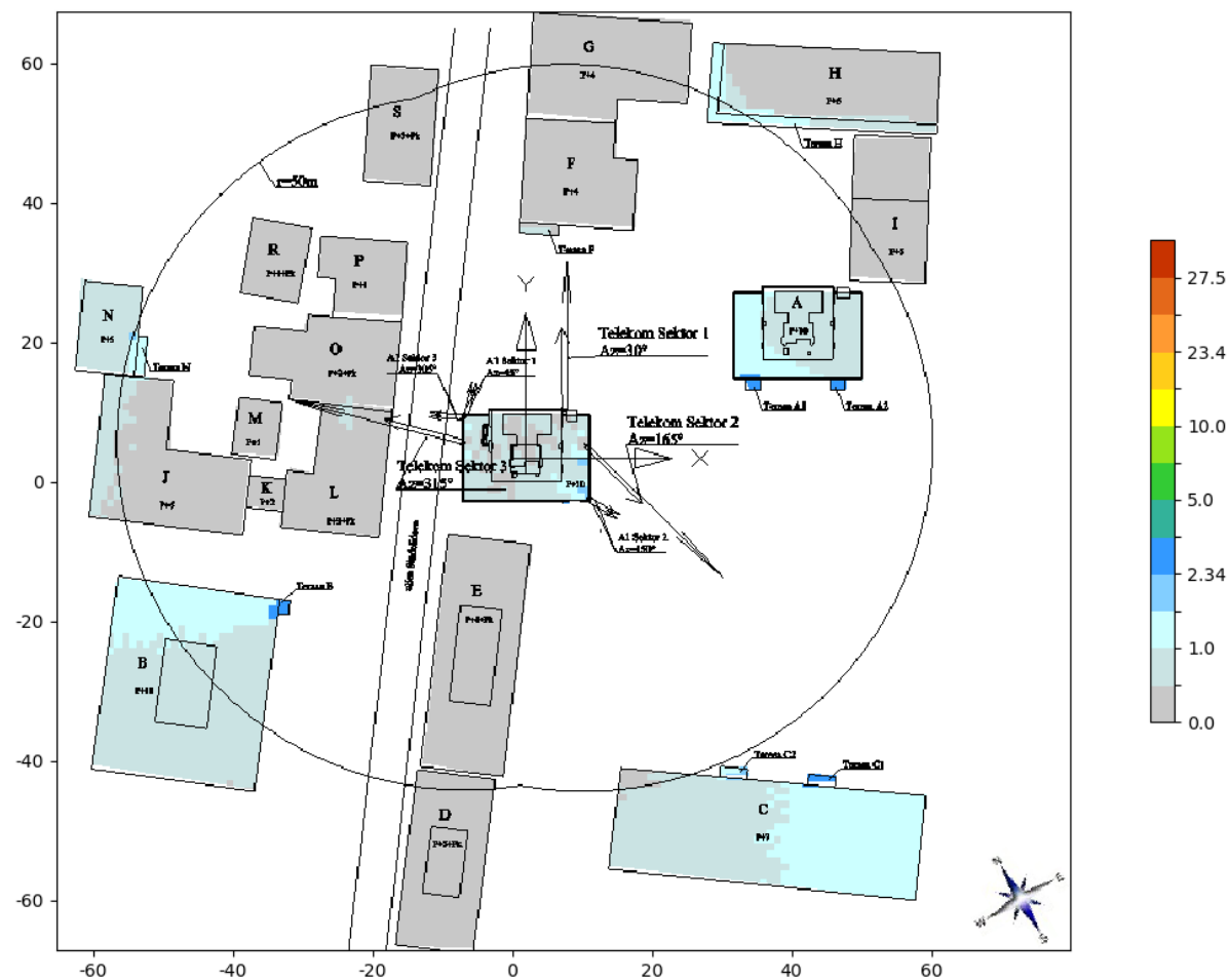
Slika 6.2. Rezultati proračuna jačine električnog polja u okolnim objektima na poslednjim spratovima/ spratovima od interesa za slučaj kada bazna stanica LTE1800 Telekom Srbija radi sa maksimalnim kapacitetom.
