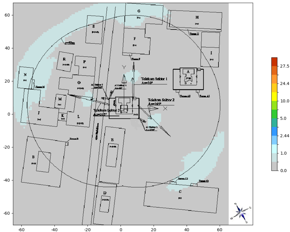
Slika 6.8. Rezultati proračuna jačine električnog polja na tlu sa uračunatom prosečnom visinom čoveka, za slučaj kada bazna stanica UMTS2100 Telekom Srbija radi sa maksimalnim kapacitetom.
