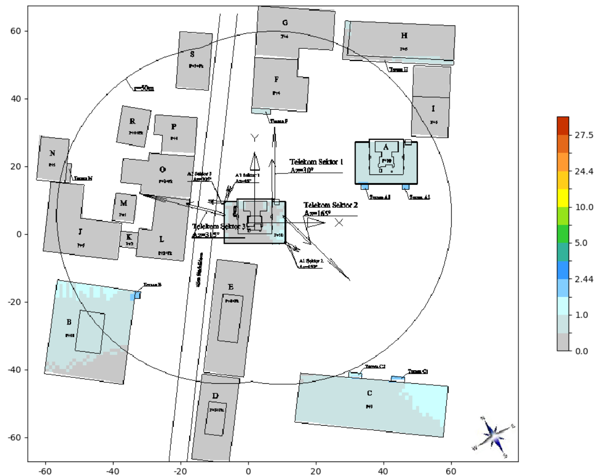
Slika 6.3. Rezultati proračuna jačine električnog polja u okolnim objektima na poslednjim spratovima/ spratovima od interesa za slučaj kada bazna stanica UMTS2100 Telekom Srbija radi sa maksimalnim kapacitetom.
