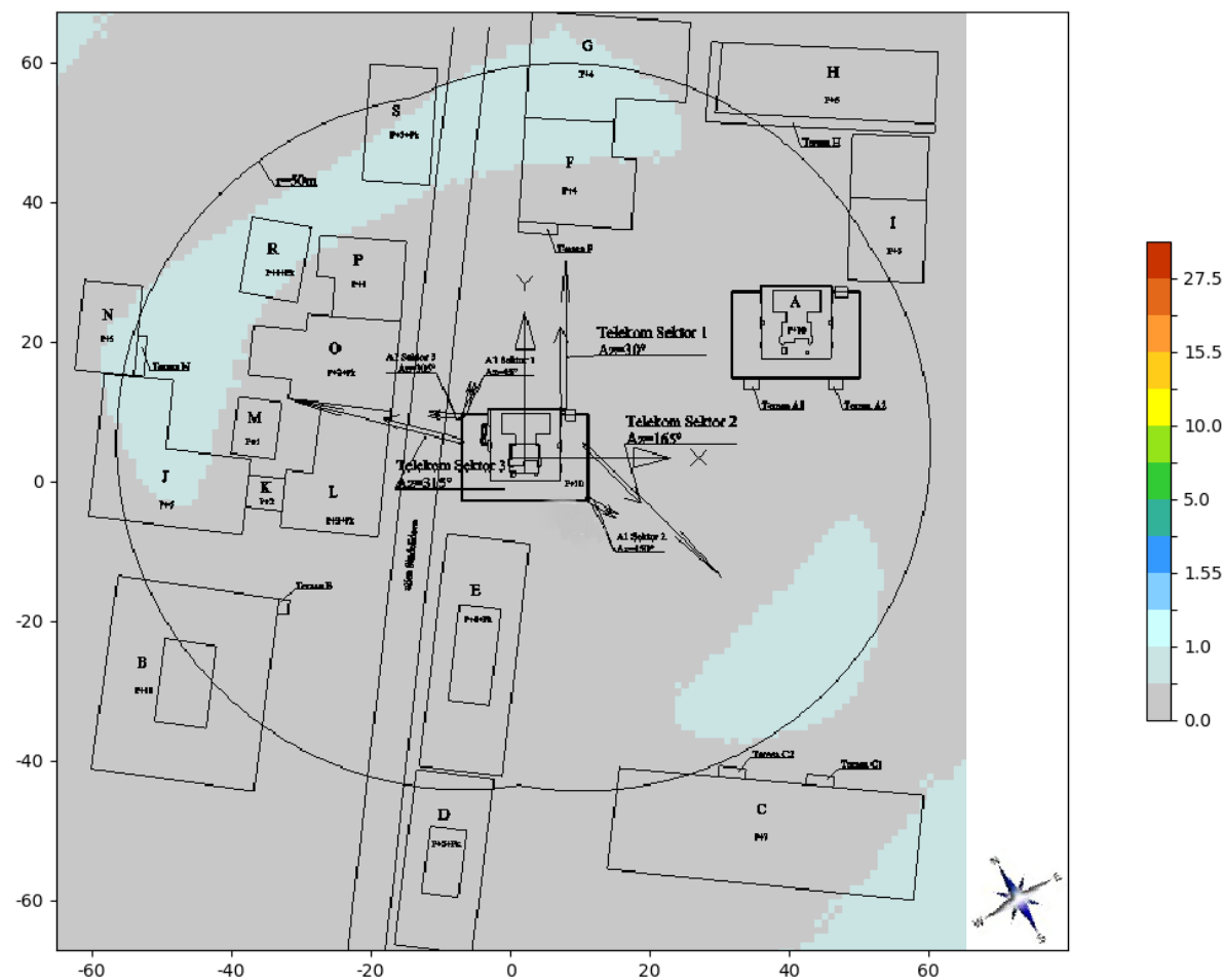
Slika 6.9. Rezultati proračuna jačine električnog polja na tlu sa uračunatom prosečnom visinom čoveka, za slučaj kada bazna stanica LTE800 Telekom Srbija radi sa maksimalnim kapacitetom.
