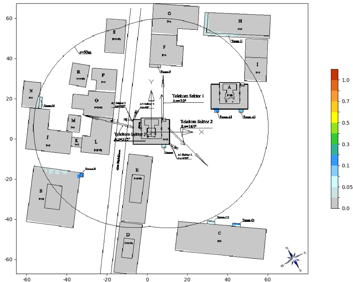
Slika 6.6. Rezultati proračuna faktora izlaganja u okolnim objektima na poslednjim spratovima/ spratovima od interesa za slučaj kada sve bazne stanice svih operatora rade sa maksimalnim kapacitetom.
