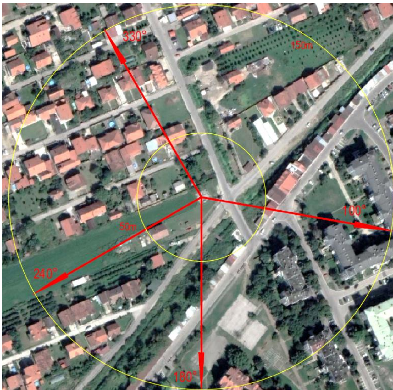
Slika 2.1 Dijagram zračenja radio bazne stanice „BG - Borca Greda” - BG589/BGU589/BGL589/BGO589/BGJ589
