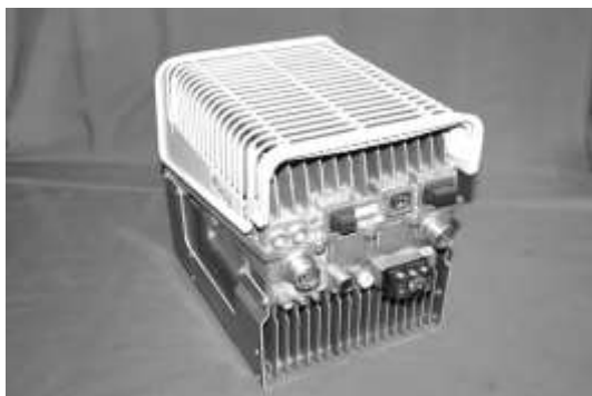
Slika 3.3 Izgled jednosektorskih Nokia Flexi radio modula
