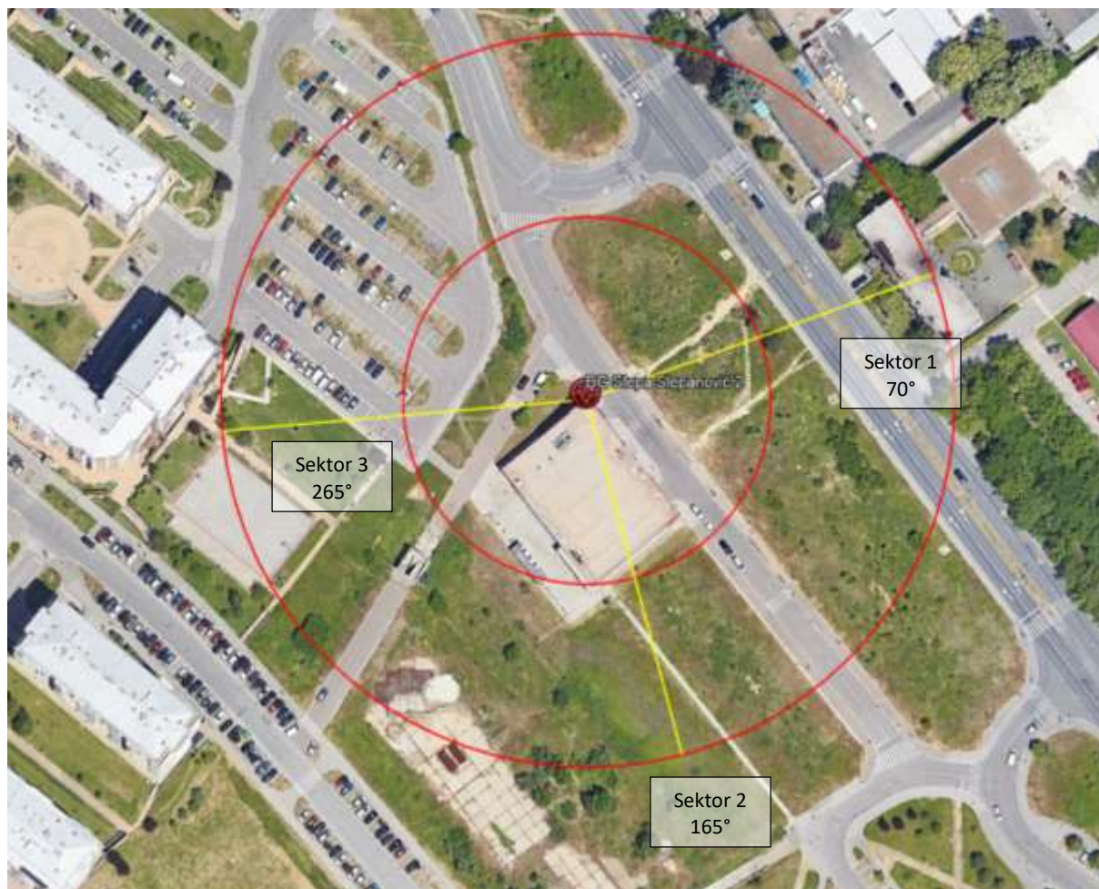
Slika 2.7 Pravci zračenja antenskog sistema BS STEPA STEPANOVIĆ 2
