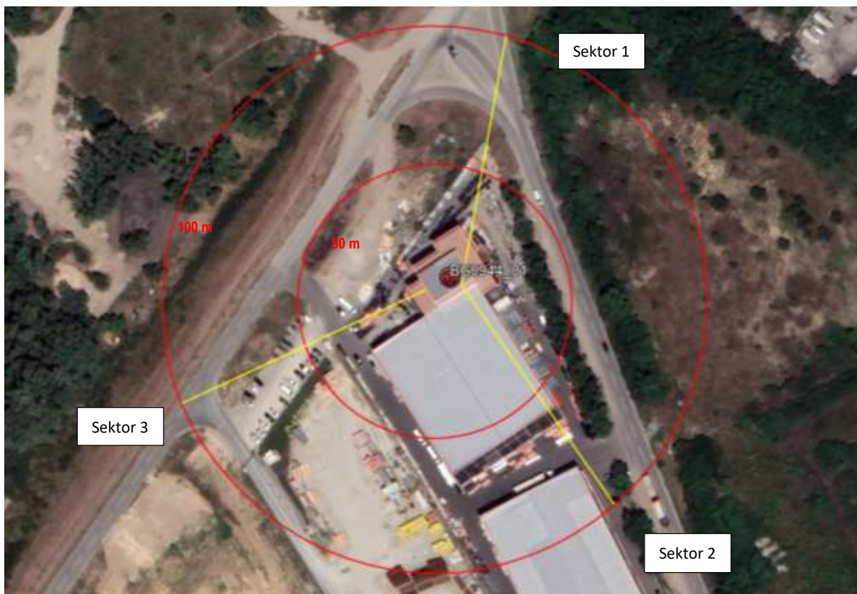
Slika 2.5 Pravci zračenja antenskih sistema predmetne bazne stanice
