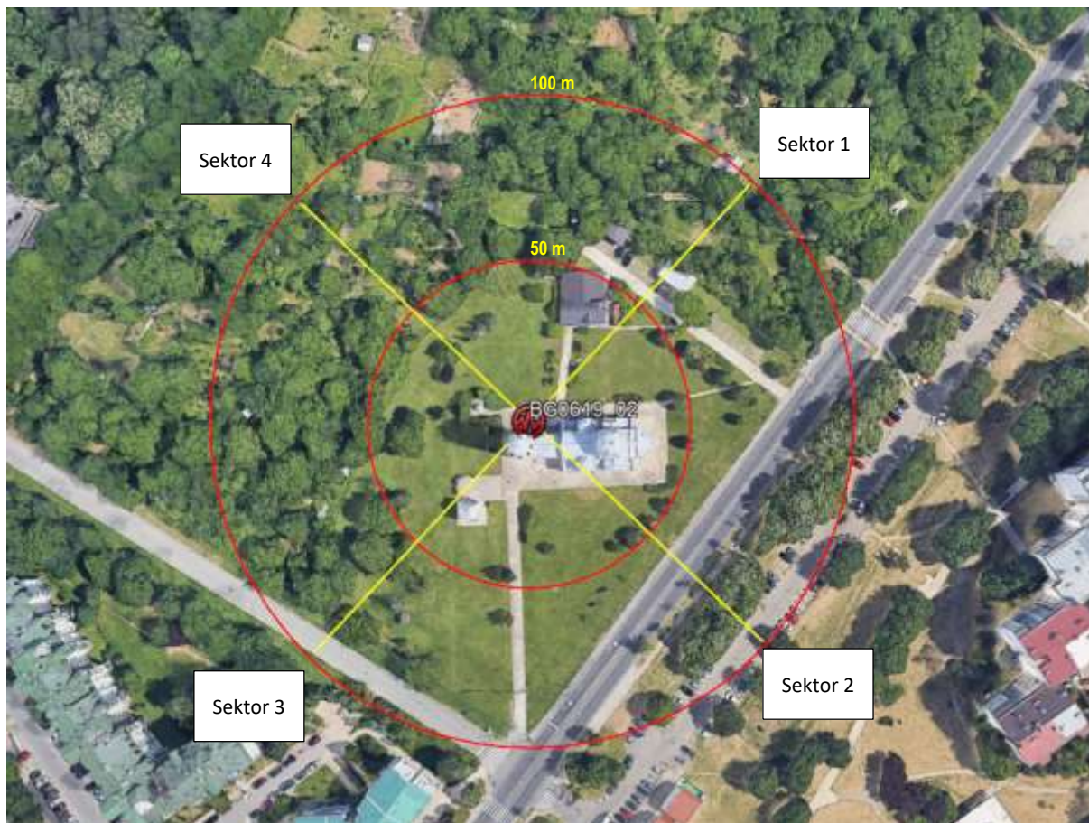
Slika 2.5 Pravci zračenja antenskih sistema predmetne bazne stanice
